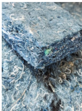
شکل ۲- استفاده از منسوجات ضایعات (سمت راست) و پشم گوسفند (تصویر سمت چپ) در تولید عایق حرارتی
