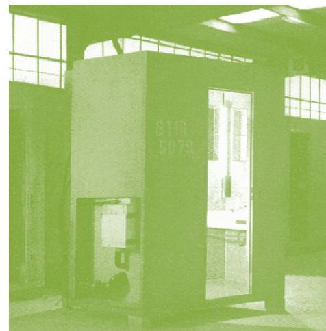
▲ شکل ۲-۶ نمونه‌ی کامل شده یک حمام پیش‌ساخته در کارخانه
