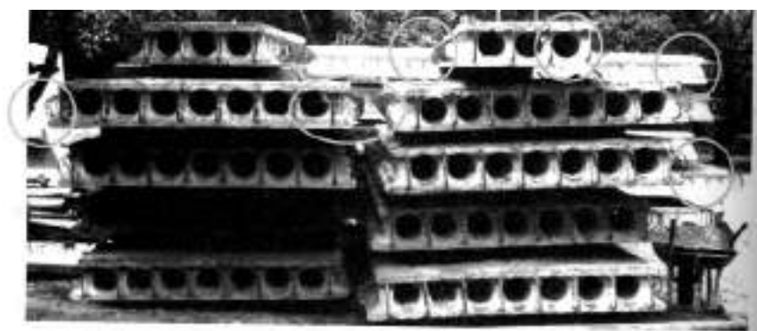
● شکل ۲-۵ میلگردهای انتظار در اطراف پانل‌های سقفی مجوف
