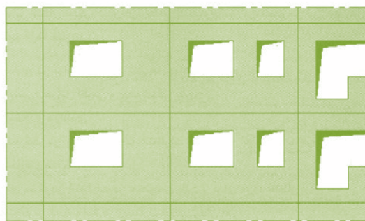
شکل ۱-۲ نمونه‌ای از قطعه‌بندی و تیپ‌بندی قطعات بزرگ نما
