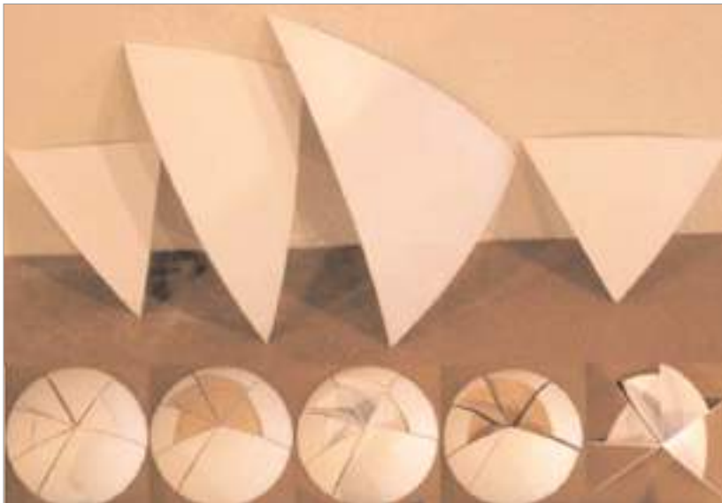
▲ تصویر ۸: چگونگی شکل‌گیری پوسته‌ها در کره‌ای به شعاع ۷۵ متر
