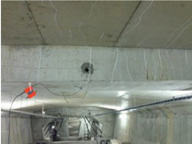
شکل ۱۱- استفاده از حسگرهای مبتنی بر انتشار آکوستیک بر روی بخش داخلی بتن پل صندوق‌های، [۵]
