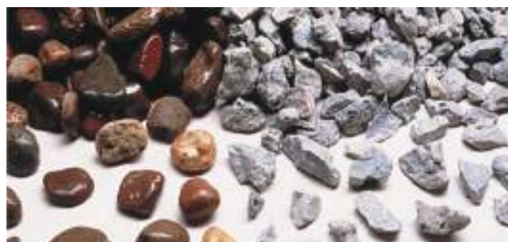
تصویر ۲۱- تفاوت مصالح رودخانه‌ای و کوهی (شکسته)
