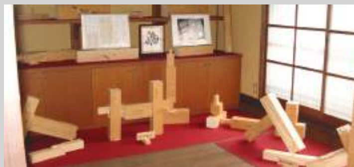
تصویر ۱۶: ساخت قطعات نمونه جهت درک بهتر سازه‌های سنتی
