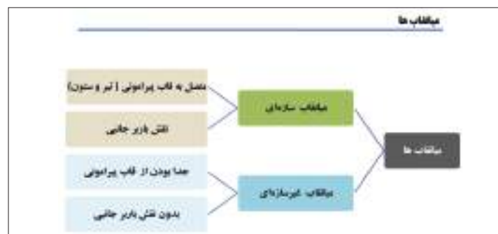
تصویر ۳- انواع دیوارهای جداکننده و میان قاب‌ها (منبع ۲)
