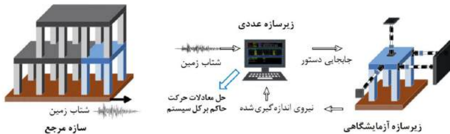
شکل ۱- نمونه‌ای از زیرسازه‌های عددی و آزمایشگاهی در یک سیستم شبیه‌سازی هیبرید [۱]
