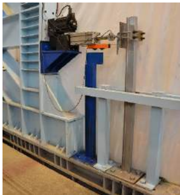
شکل ۷- شبیه‌سازی ترکیبی یکی سیستم یک درجه آزادی (جرم و میرایی نمونه به صورت عددی در نرم افزار MATLAB مدل شده و سختی نمونه به صورت آزمایشگاهی ساخته شده است؛ این سیستم جهت بررسی ایده‌ها و روش‌های نوین در توسعه روش شبیه‌سازی هیبرید استفاده می‌گردد) [۷]
