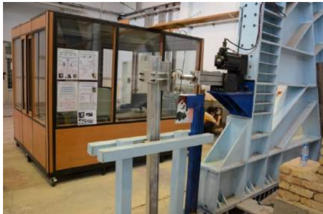
شکل ۵- نمایی از آزمایشگاه فیزیکی سیستم شبیه‌سازی هیبرید دانشگاه تربیت مدرس [۷]
