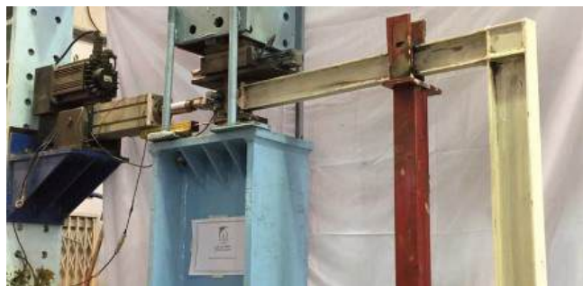
شکل ۶- ارزیابی عملکرد قابی اتصال پیشنهادی بهبود یافته تیر با عرض بال افزایش یافته به ستون با استفاده از شبیه‌سازی ترکیبی (نیمه راست قاب با اتصال نوین پیشنهادی به عنوان زیرسازه آزمایشگاهی به صورت فیزیکی و نیمه چپ قاب در نرم‌افزار OpenSees مدل شده است) [۸]
