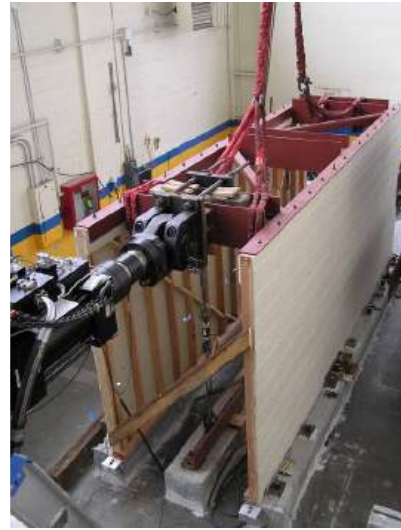
شکل ۹- زیرسازه آزمایشگاهی از سیستم شبیه‌سازی هیبرید آزمایشگاه دانشگاه برکلی برای تست یک خانه چوبی [۶]
